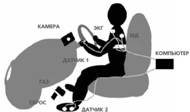
Рис. 1. Структурная схема системы контроля психо-физиологического состояния водителя транспортного средства.
