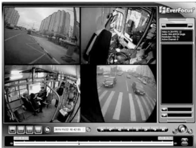
Видеорегистратор EMV400S является профессиональной 4-х канальной мобильной системой, предназначенной для непрерывной записи видео- и аудио-файлов с максимальной скоростью 100 к/с и разрешением 720×576 (запись в реальном времени). Для каждого видео входа настройка параметров осуществляется индивидуально. Несмотря на свой компактный размер, EMV400S имеет промышленное исполнение и может использоваться в системах с повышенными требованиями к надежности и функциональному назначению.
