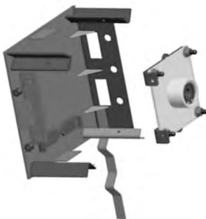
Рис. 3. Общий вид боковой крышки с деталями крепления вала
