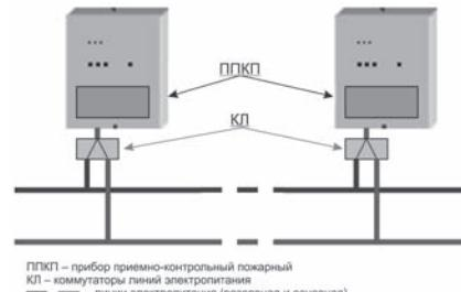
Рис... Пример подключения двух линий через коммутаторы
