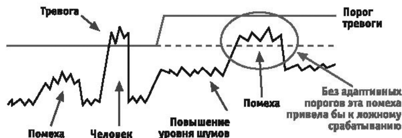
Рис. 3. Адаптивный порог СВЧ-канала обнаружения
