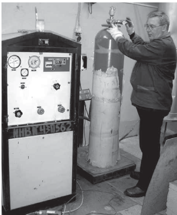
Заправка баллонов огнегасящими составами
