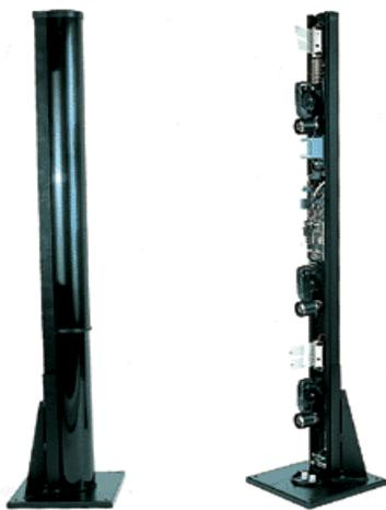
Установленный на колонну передатчик посылает приемнику на противоположной колонне, как инфракрасный луч, так и сигнал синхронизации по электрическому кабелю. Приемник принимает инфракрасный импульс только в тот момент, когда он получает по кабелю сигнал синхронизации. Приемник не реагирует на внешнюю засветку (*в инфракрасном и видимом спектре*), делая извещатель нечувствительным к солнечным лучам.
