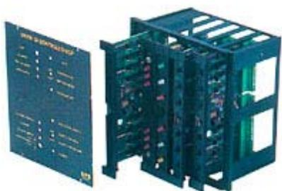
Концентратор (на базе микропроцессора), расположенный в колонне, благодаря цифровой обработке сигналов, может контролировать до восьми (одиночных или двойных) лучей, расположенных в колонне. Добавляя опционные платы реле, можно выводить сигналы тревоги (выход реле) для каждого отдельного луча (пары лучей). На блок управления можно вывести до 16 концентраторов (используя один кабель).
