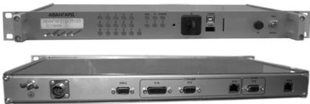
АПК «Авангард» предназначен для криптографической защиты конфиденциальной информации, передаваемой по цифровым каналам Е1 со скоростью до 2 Мбит/с.
