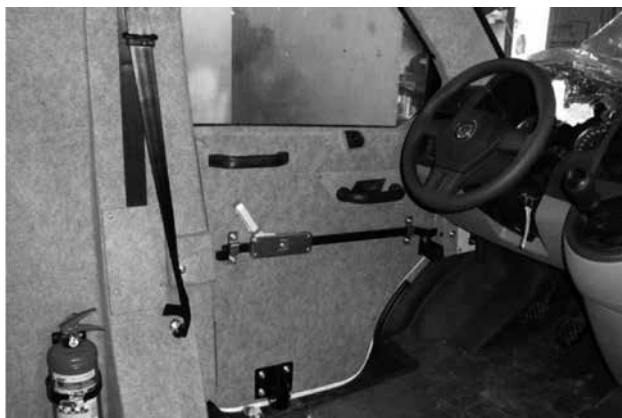
Рис. 10 Кабина броневедомобиля для инкассации перед установкой сидений
