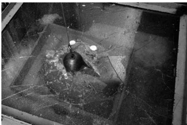
Рис. 7 Испытание противоударных стекол
