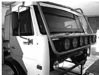
Рис. 2. Кабина автомобиля КамАЗ, бронированная по 5-му классу стойкости к воздействию стрелкового оружия
