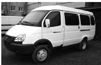
Рис. 3. Броневан автомобиль на базе ГАЗ-27057 (Газель) по 3-му классу стойкости к воздействию стрелкового оружия
