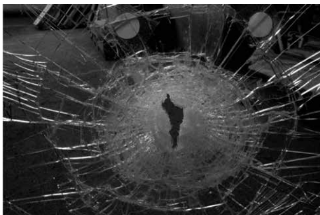
Рис. 8 Результат испытаний (образец стекла не прошел испытание ударом)
