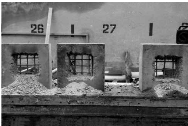
Рис. 11 Образцы ограждающих конструкций хранилища ценностей после испытаний
