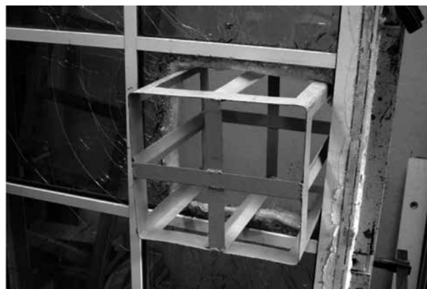
Рис. 2 Противовзломное окно – результат взлома (отверстие с шаблоном для полного проникновения)
