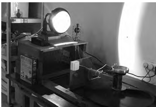
Рис. 15. Установка проверки внешней засветки по ГОСТ Р 50777
