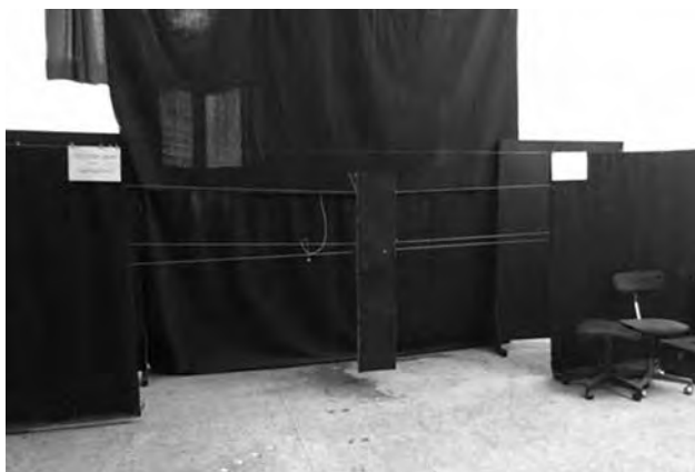
Рис. 18. Стандартная цель по ГОСТ Р 50777 для испытаний пассивных инфракрасных извещателей
