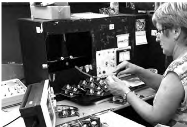
Рис. 13. Стенд ПСИ оптико-электронных извещателей
