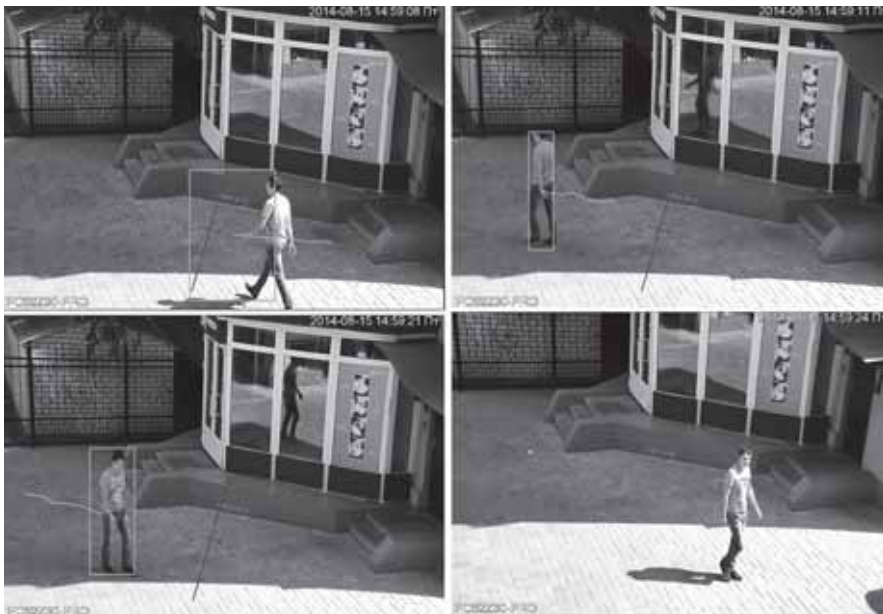
Рис. 3 Алгоритм контроля пересечения линии
