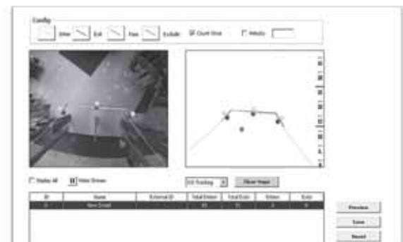
Рис. 4. Интерфейс управления 2D-видеосчетчиком. Уникальная система фильтров позволяет реализовать широкий спектр задач подсчета при одновременном повышении качества определения событий
