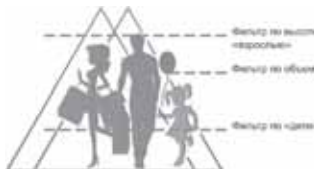
Рис. 11. Исключение объектов по форме и высоте, не соответствующие «параметрам клиента» (воздушный шарик, тележки, коробки и т.п.).
