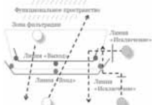
Рис. 7. Фильтрация объектов по траектории движения. Дает возможность исключать из подсчета персонал торговой точки (с помощью настройки линии «исключение» персонал, двигающийся по определенной несвойственной посетителям траектории, можно выделить из потока клиентов).
