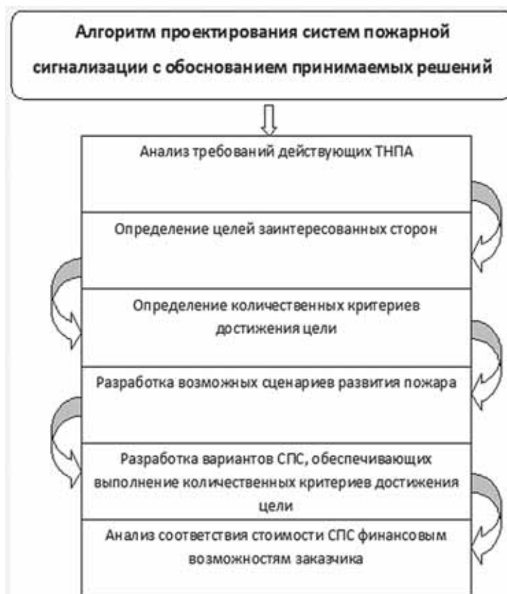
Рис. 1. Этапы проектирования системы пожарной сигнализации с обоснованием принимаемых решений
