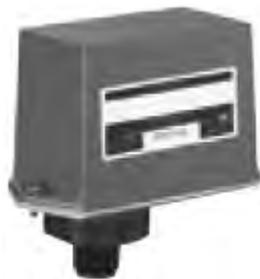
Сигнализаторы давления Potter PS10 применяются в качестве средств инициирования электрических сигналов при падении давления в системе. Данные сигнализаторы давления также используются в качестве «управляющих выключателей сигнала тревоги по низкому давлению» в пилотных противопожарных системах с минимальным управляющим давлением 0,056 МПа.
