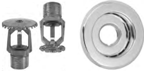
Ороситель спринклерный водяной ТУ3151, ТУ4151, ТУ3251, ТУ4251 стандартного реагирования со стандартной зоной орошения, устанавливаемые вертикально розеткой вверх (ТУ3151, ТУ4151), устанавливаемые вертикально розеткой вниз/утопленные (ТУ3251, ТУ4251).
