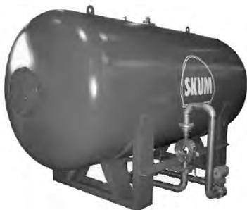
Бак-дозатор используется для выпуска пенного концентрата в водяные системы с различным расходом и/или давлением. Система идеально подходит для переоснащения водяной спринклерной системы с возможностью использования пены и воды. Постоянное смешивание, независимо от расхода, достигается за счет выравнивания давления между пенной жидкостью в баке-дозаторе и участком с водой в системе, пропускаемой через смеситель.
