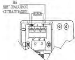
Подключение сигнала высокого давления
