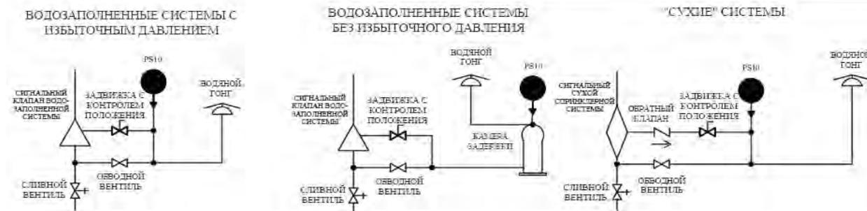
**Внимание!** Закрытие любого из запорных клапанов, находящихся между проверочным сигнальным клапаном и PS10 приведет к бездействию PS10
