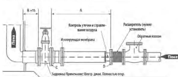
Типовая схема установки в основании бака
