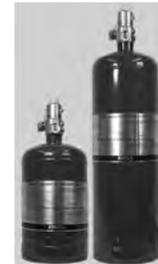
**Клапана для баллонов** бывают двух размеров: 25 мм и 50 мм, в зависимости от емкости используемого баллона. Клапаны сконструированы таким образом, чтобы обеспечить высокую скорость разгрузки и выпустить все содержимое баллона в течение десяти секунд. Клапан приводится в действие соленоидным, ручным или пневматическим приводным устройством. Для определения давления в баллоне в стандартной комплектации устанавливается манометр.
