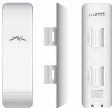
В NanoStation M2 применяется встроенная двухполяризованная антенна MIMO усилением 11 dBi. В комплект устройства входит блок питания POE-24 и крепление на мачту. Nanostation M2 за счет своих расширенных возможностей, используется в беспроводных сетях большей емкости, не увеличивая при этом цену.
